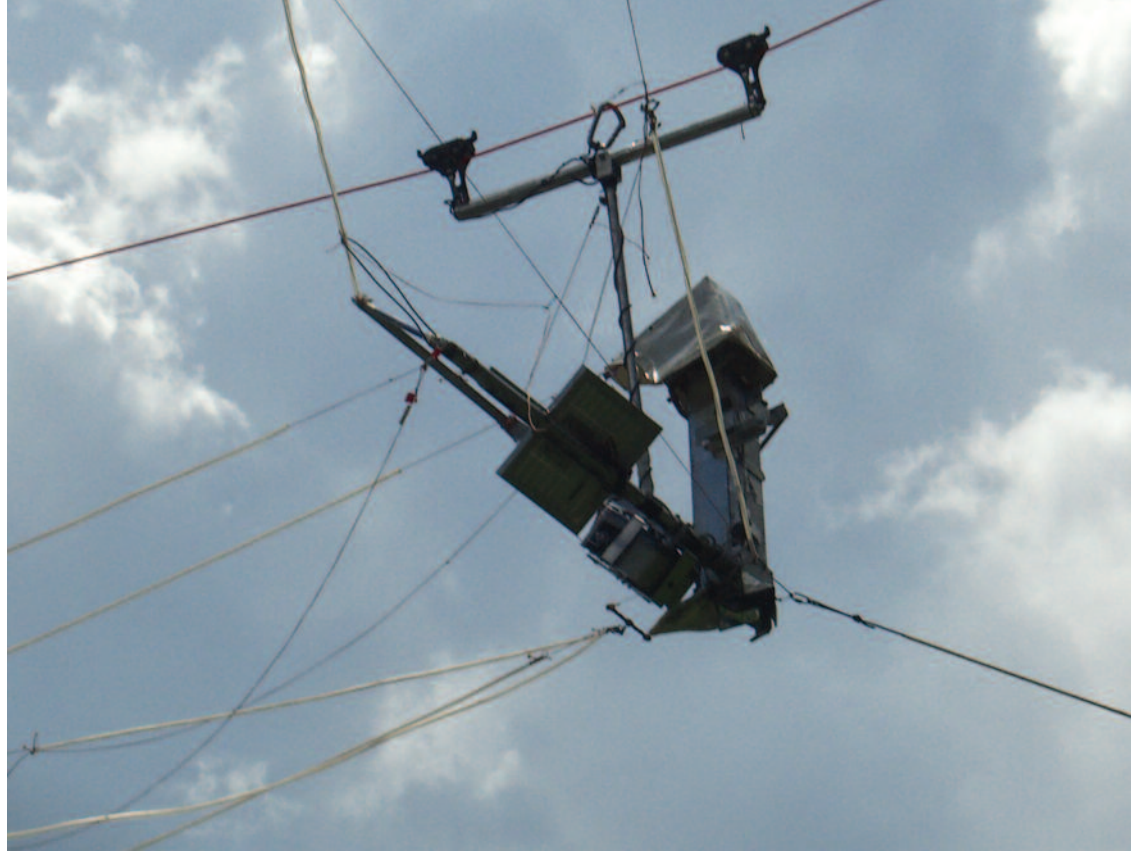
La nacelle suspendue au foyer du méta-miroir primaire. Deux roulettes lui permettent de rouler sur le câble de suspension (noir) qui traverse la vallée à 100 m de hauteur.
