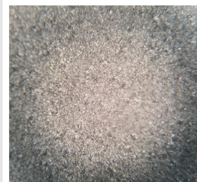
Vue au microscope de l'état de surface du miroir avant le polissage
